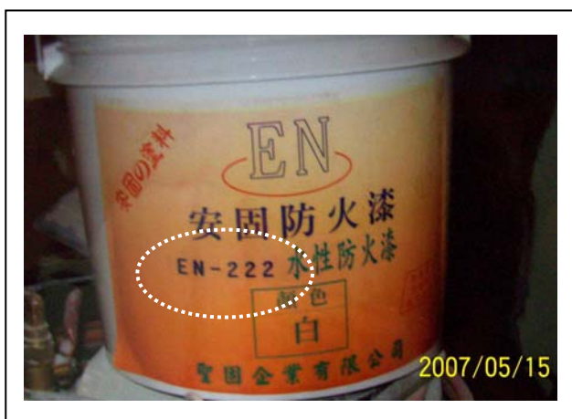
▲ 使用防火塗料者，竣工照片應呈現防火塗料容器上所標示之產品編號。
