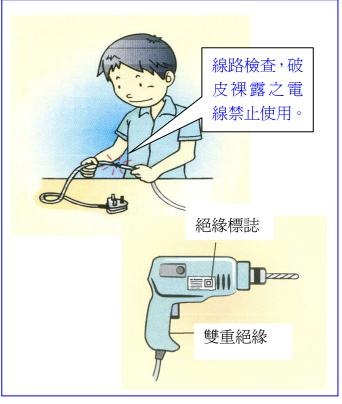
▲ 電動手提工具宜採用具有雙重絕緣標誌者 ,在插電使用前,並應仔細檢查線路及插 頭狀況是否正常。
